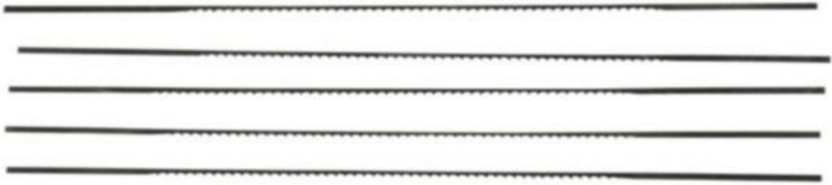
Рисунок 2.8 – Пилочки з дрібними зубчиками
