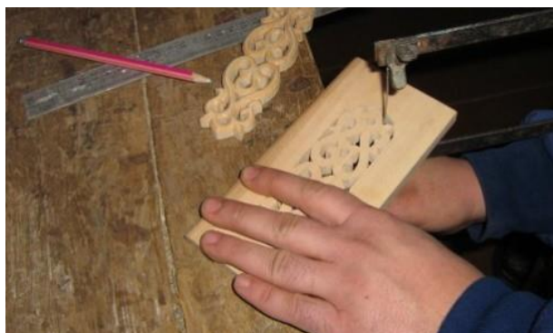
Рисунок 1.5 – Художнє випилювання за допомогою ручного лобзика
