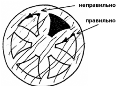
Рисунок 2.18 – Випилювання внутрішнього орнаменту
