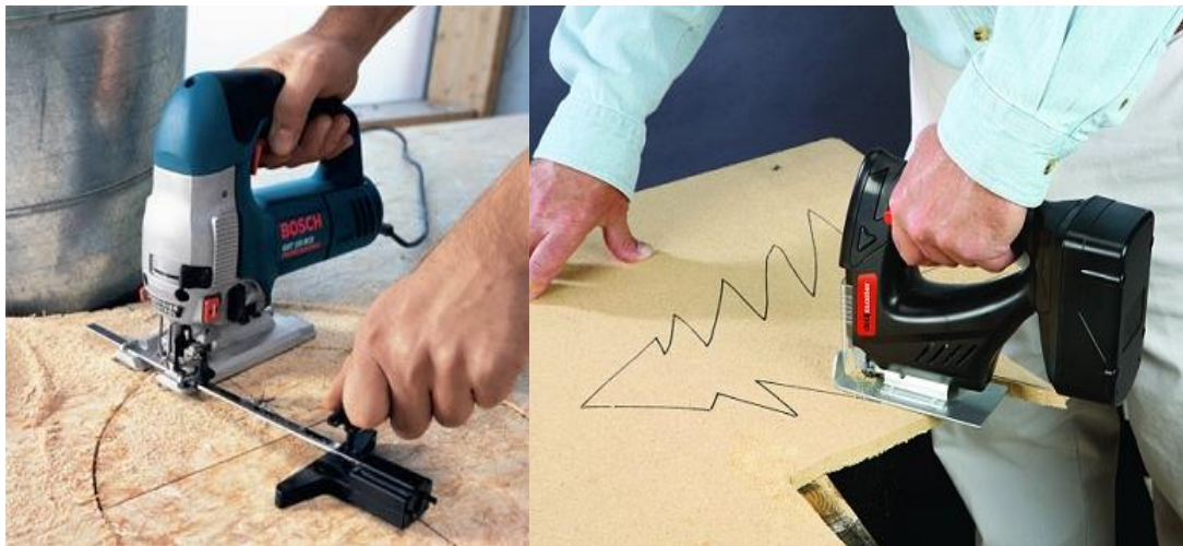
Рисунок 1.3 – Випилювання ручним електричним лобзиком
