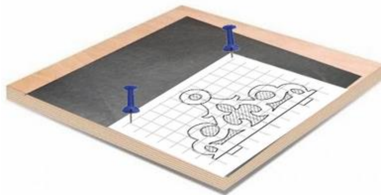
Рисунок 2.26 – Розмічання за допомогою копіювального паперу
