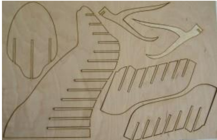
Рисунок 5.2 – Пазове з'єднання в скелетних виробках
