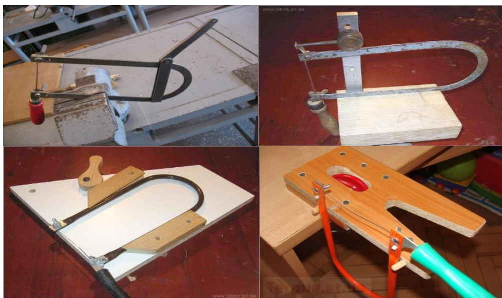
Рисунок 2.10 – Пристосування для стискання лобзика
