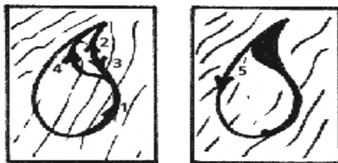
Рисунок 2.16 – Прийом випилювання гострого кута
